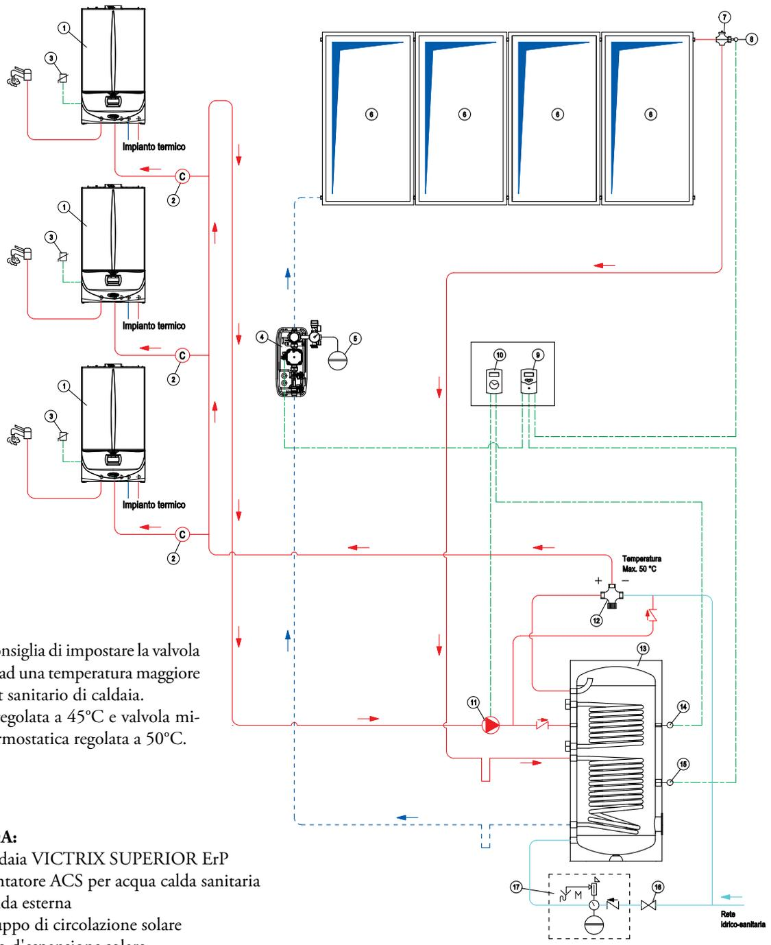
**NOTA:** si consiglia di impostare la valvola miscelatrice ad una temperatura maggiore del set-point sanitario di caldaia.
